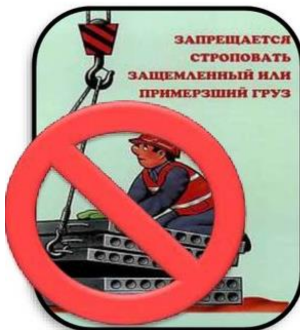
Рис. 7 Пример нарушения при освобождении защемлённых грузов
