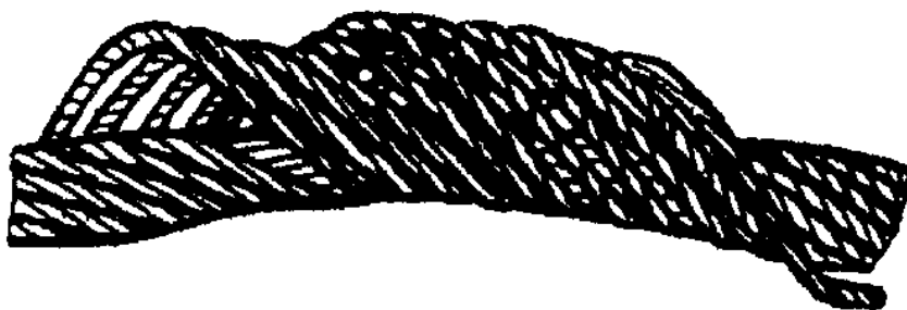
Рис. 22 Корзинообразная деформация
