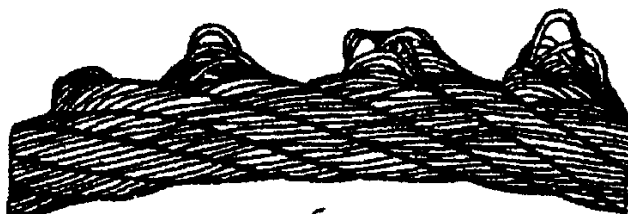
Рис. 24 Выдавливание проволок прядей
