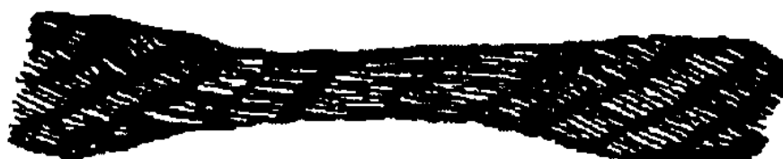
Рис. 25 Местное увеличение диаметра каната
