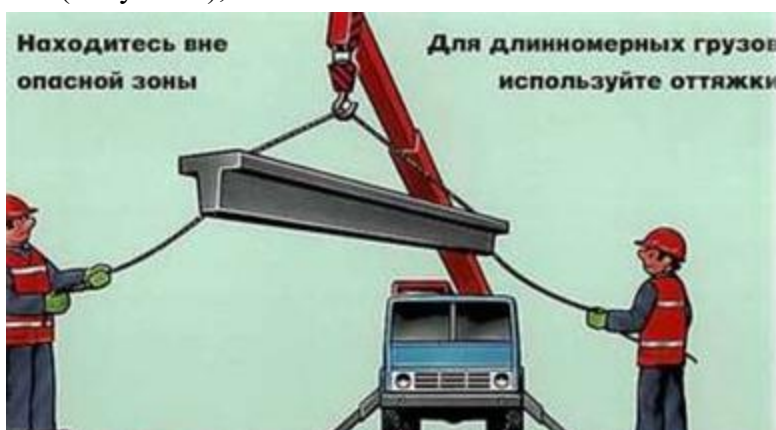
Рис. 8 Правило при оттягивании груза во время его подъёма, перемещения и опускания
