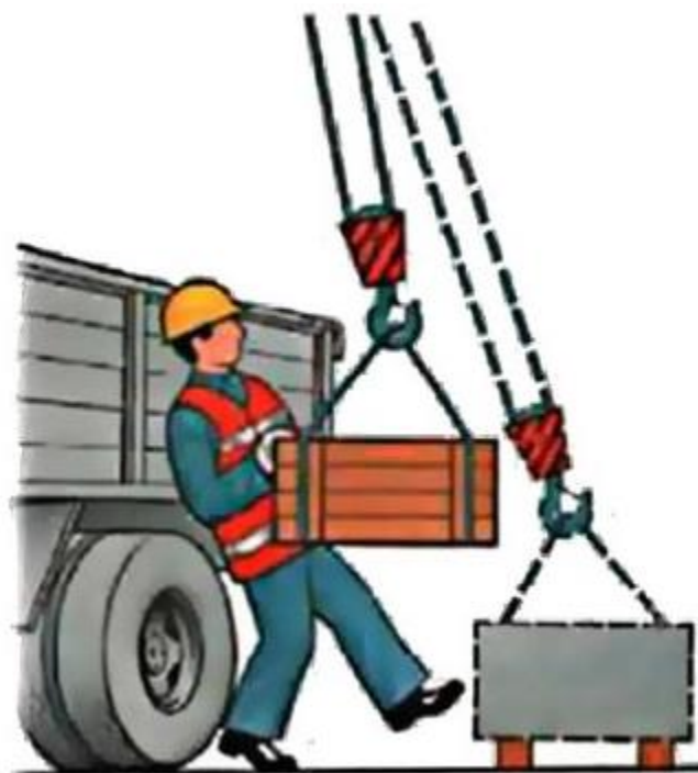
Рис. 11 Пример нарушения техники безопасности при наклонном положении грузовых канатов
