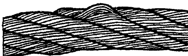
Рис. 23 Выдавливание сердечника
