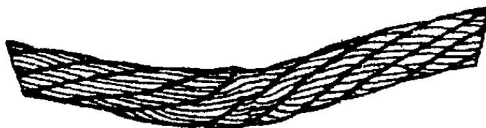
Рис. 28 Залом каната
