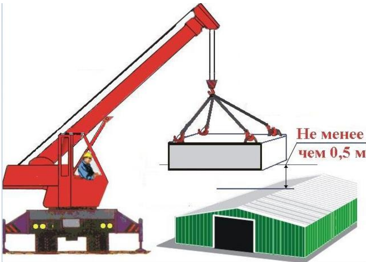
Рис. 5 Допускаемая высота груза при встречающихся на пути препятствий
