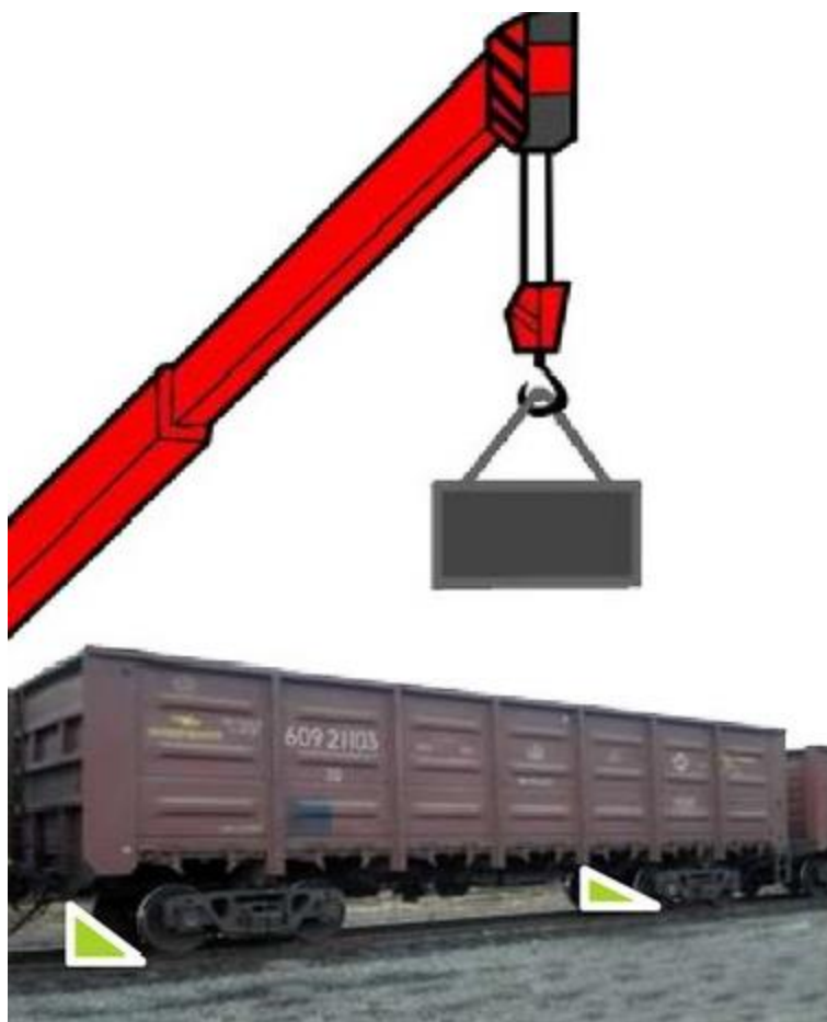
Рис. 10 Соблюдение равновесия при погрузке и разгрузке полувагона
