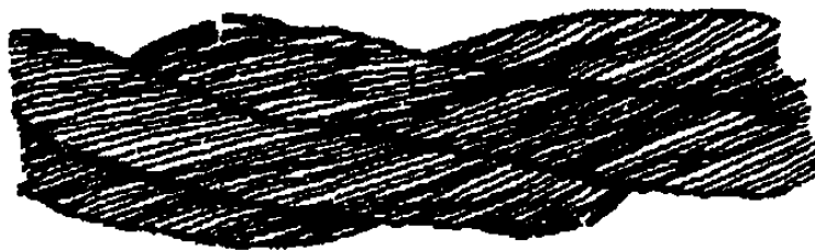
Рис. 13 Обрывы и смещения проволок каната крестовой свивки
