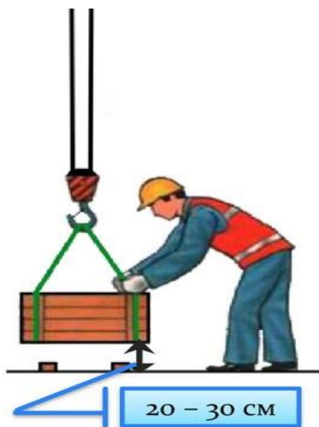
Рис. 2 Правильное начало подъёма груза
